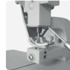
4. Nun noch die Befestigung der Rückholfeder lösen und Ösenkanal entfernen.
