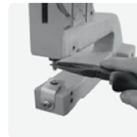
6. Ziehen Sie nun den Fangstift vorsichtig mit einer Zange aus dem Zylinder heraus.
