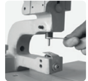
5. Schrauben Sie den Oberstempel mit dem Gabelschlüssel aus dem Zylinder.
