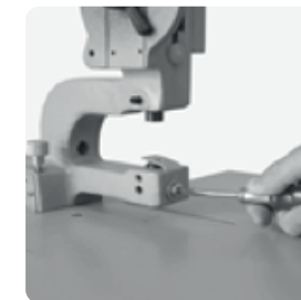
7. Nun die Verschraubung der Abstreiffeder lösen und Abstreiffeder entfernen.
